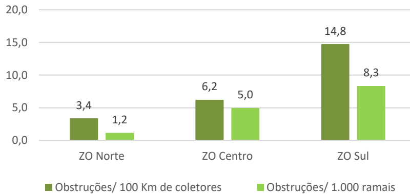
Figura 24 – Desobstrução em coletores e ramais – 2025
